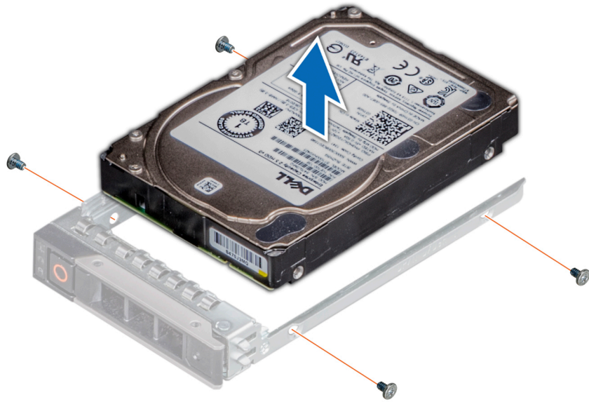
图 34: 从硬盘驱动器托盘中卸下硬盘驱动器
