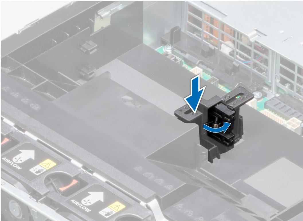
图 48: 打开 PCIe 卡固定器门锁
