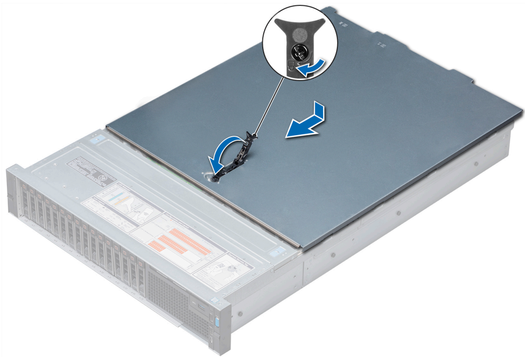
图 18: 安装系统护盖
